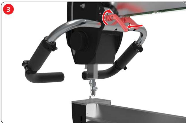
> Tourner la bague d'arrêt seulement suffisamment pour que le levier de blocage puisse encore être abaissé en exerçant une légère pression.
