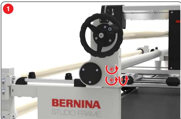
> Desserrer respectivement 3 vis à droite et à gauche.
